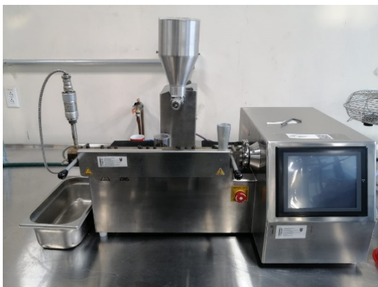
Figura 1. Extrusor de doble husillo Thermo Scientific® Process 11.
