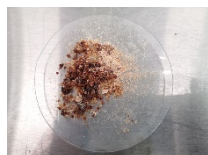
Figura 3. Sólido obtenido a partir de la reacción que involucra el epóxido, CO 2 y la perovskita como catalizador.
