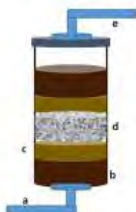
Figura 2. Esquema del filtro empacado. a) entrada al filtro; b) piedra volcánica; c) arena; d) esferas de Quitosano-PVA
