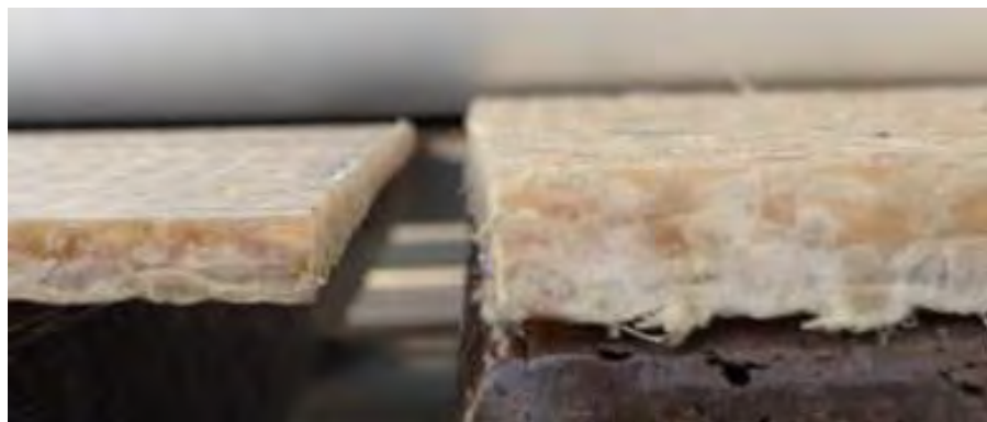
Figura 1. Espesores logrados según el proceso de manufactura para materiales con el mismo apilamiento. Derecha proceso de infusión. Izquierda: proceso propuesto infusión+compresión.
