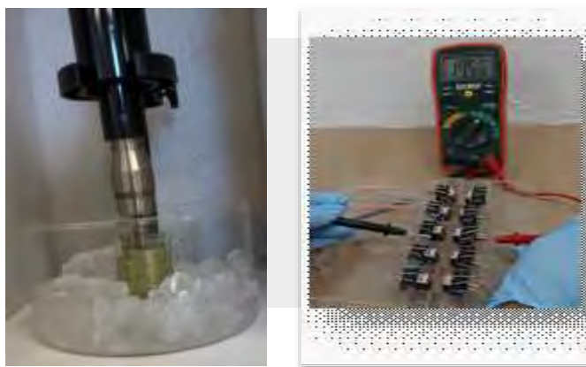
Figura 1. Punta sónica y determinación de la resistencia eléctrica e fibras de twaron con depósitos de NTC.
