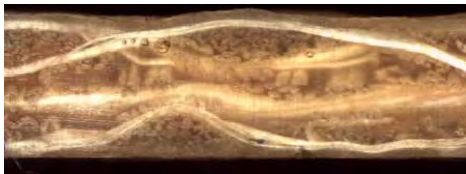
Figura 2 Microscopía de una sección del material obtenido por el proceso de fabricación propuesto. Se puede ver el bajo contenido de poros y la distribución adecuada de la resina
