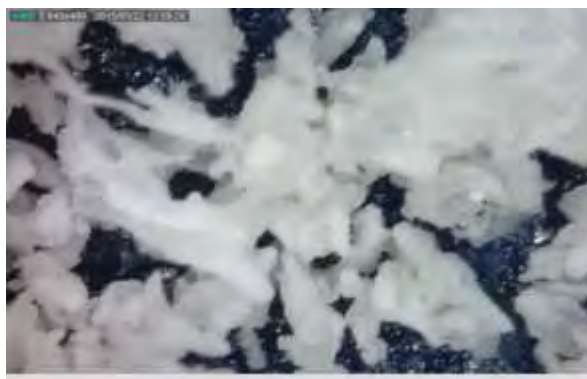
Figura 1. Imagen de microscopia óptica (200x) de la celulosa extraída del bagazo de piña a 7.5% en peso de KOH y a 40 °C
