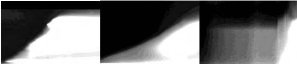
Figura 1. Termografía espacio (eje vertical) vs. tiempo (eje horizontal) de una polimerización frontal en una pipeta Pasteur: una sola línea de pixeles se toma verticalmente de cada cuadro de termografía de la pipeta en el tiempo. Al juntarlos todos se obtiene el diagrama espacio-tiempo mostrado. Cada diagrama presenta aprox. 10 min en el eje horizontal y 8 cm en el vertical. De izquierda a derecha, se muestra la polimerización con el iniciador sobre un hilo de algodón dentro de la pipeta, formando una emulsión y a la derecha, formando previamente una microemulsión dentro de micelas de SDS.
