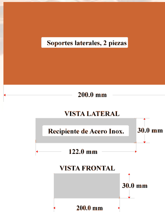
Figura 4, Dimensiones del soporte de los cilindros y del recipiente de acero inoxidable, para la solución polimérica.
