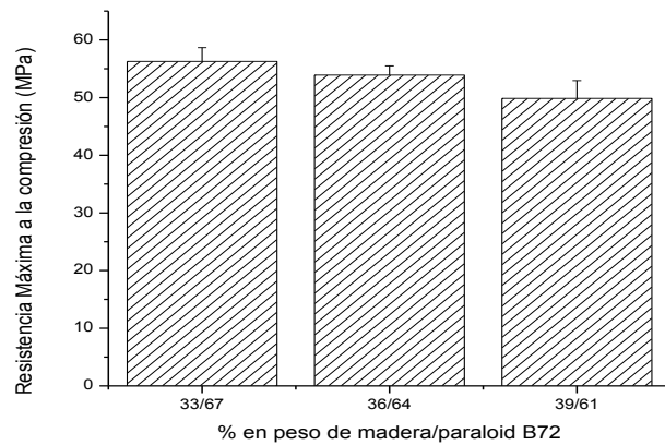
Figura 5 Resistencia máxima a la compresión en función de la cantidad de madera.
