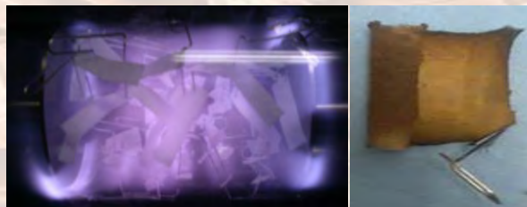
Figura 2. a) Polimerización por plasma b) Matriz cubierta con Polipirrol.
