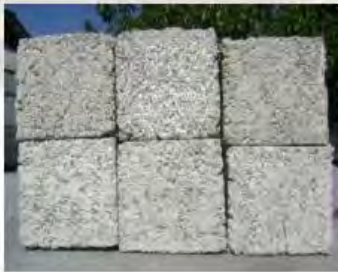
Figura 2. Apariencia del mortero hidráulico endurecido modificado con PET
