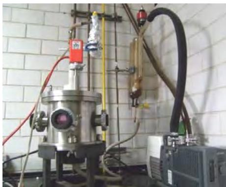
Figura 1. Reactor de plasma de electrodos aislados
