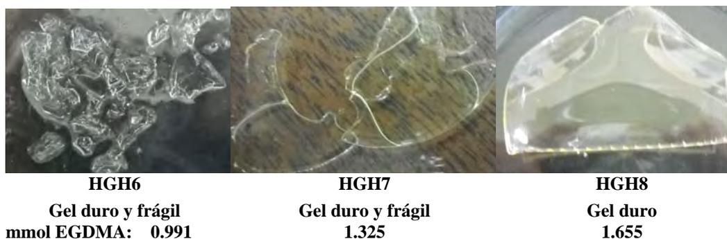
Figura 4. Muestras de gel formado de HEMA y EGDMA, sintetizadas a 70°C, 24 horas de reacción y DMF.
