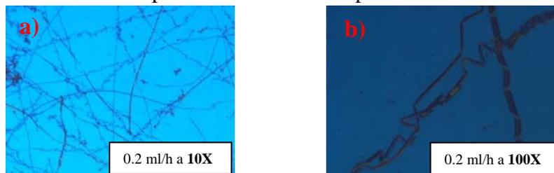
**Figura 5.** Imágenes de fibras obtenidas por Microscopía Óptica. a) Vista a 10 X. b) Vista a 100 X.
