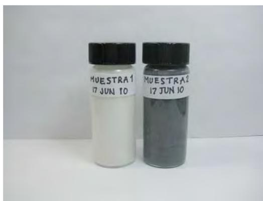
**Figura 2.** Imagen de pintura vinil acrílica comercial color blanco ( muestra 1 ) y pintura vinil acrílica formulada con grafeno modificado químicamente al 1% w.t ( muestra 2 )
