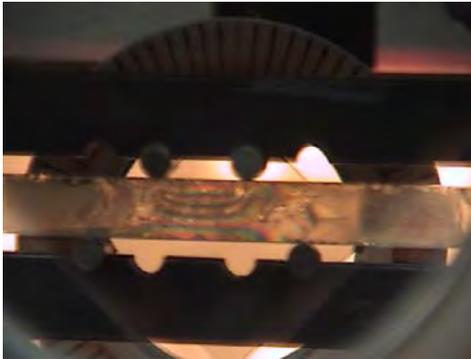
Figura 1. Patrones fotoelásticos de una probeta. sometida a carga por flexión.
