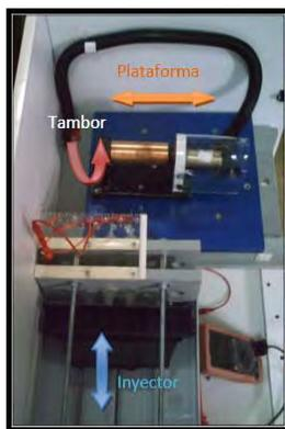
Fig. 1 Equipo de electrospinning
