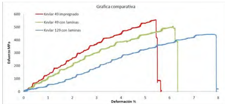
Figura 3. Resultado de tensión de compuestos Kevlar® 129/PP y Kevlar® 49/PP.
