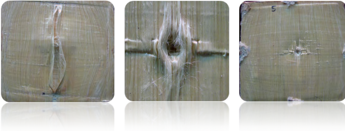
Figura 7. Muestra de Kevlar ® 49/PP por polvos (7 capas) impactada con una energía de E = 93.8 Joules.
